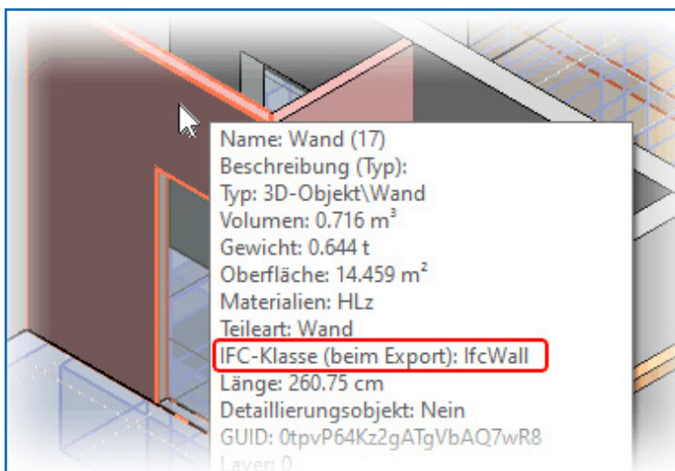
Abbildung 7: Tooltip mit der hinterlegten IFC-Klasse des Objektes
