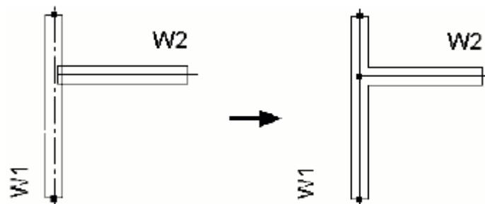
Bild 3: Außenkante - Punkt - Verbindung
