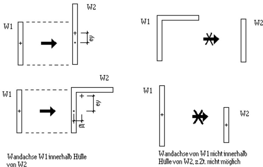
Für eine Lastweiterleitung von einer Stütze auf einen Wandpfeiler oder auf eine Stütze muss der Schwerpunkt der oberen Stütze innerhalb der Hülle des darunter liegenden Wandpfeilers bzw. der darunter liegenden Stütze liegen.
