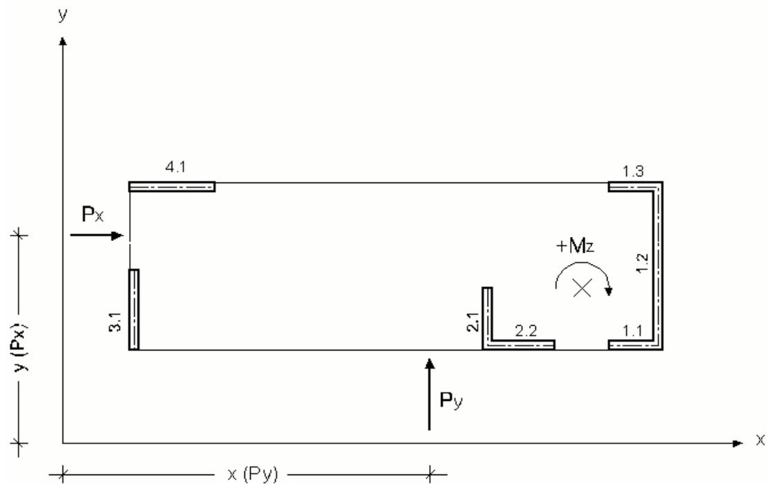
Horizontallasten können über entsprechende Buttons als Wind in X-, Y- bzw. X+Y- Richtung nach Eingabe der Windlastparameter automatisch generiert werden.
