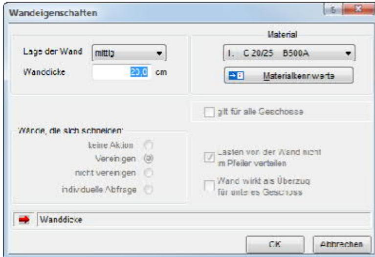
Findet keine Vereinigung statt, bildet die eingegebene Wand einen neuen Pfeiler. Die Wandachse wird dennoch bis zur Wandachse des geschnittenen Pfeilers verlängert, dessen Hülle am Schnittpunkt mit der Hülle des geschnittenen Pfeilers endet.
