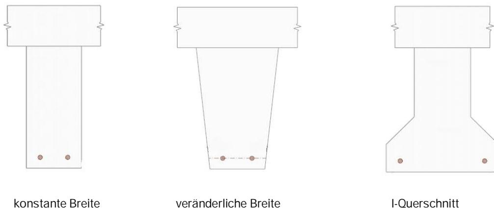
Für Balken mit veränderlicher Breite kann die Breite in Höhe der der Bewehrungsschwerlage verwendet werden.
