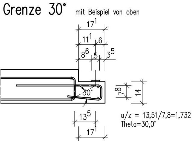
und bei Druckstrebenneigung zwischen 30° und 26,565° mit 2 Bügeln
