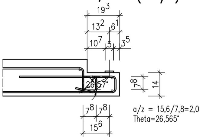
Hier wird der untere Schenkel des äußeren Bügels gerade durchgeführt und der innere (zusätzliche) Bügel wird unten aufgebogen und über den Querstab geführt.
