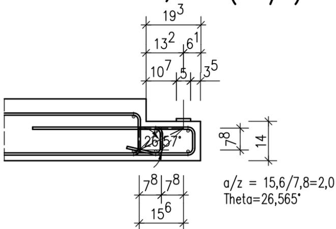
Hier wird der untere Schenkel des äußeren Bügels gerade durchgeführt und der innere (zusätzliche) Bügel wird unten aufgehängt und über den Querstab geführt.
