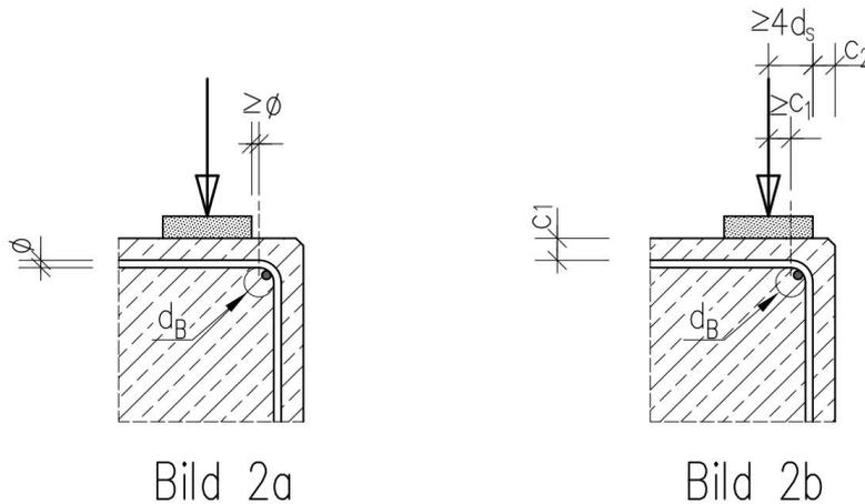
Bei einer maximalen Lagerpressung von  $\sigma_k < 0,08 f_{ck}$  kann gemäß /7/BK 2009 von der vorgenannten Regelung abgewichen werden (s. Bild 2b)
