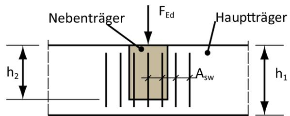
Bedingung für indirekte Lagerung:  $h_1 - h_2 < h_2$
