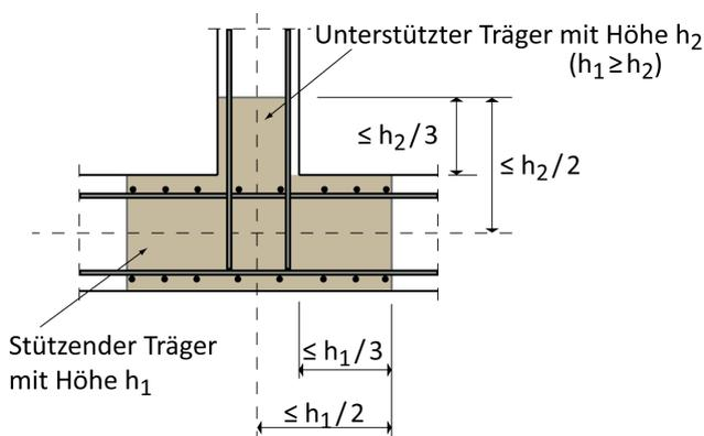
Werden die Bügel in den Bereichen  $h_1/3$  bzw.  $h_2/3$  (Kreuzungsbereich) ausgelagert, muss eine horizontale Bewehrung gleichen Querschnitts wie die ausgelagerten Bügel angeordnet werden.
