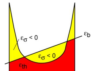
Für den Beton ergibt sich damit ein typisches Tragverhalten, bei dem sich ein schmaler äußerer Ring aufgrund der bei hohen Temperaturen stark abgeminderten Spannungsdehnungslinien und ein innerer Bereich mit  $\varepsilon_{\sigma} > 0$  (Zug) der Mitwirkung entziehen.
