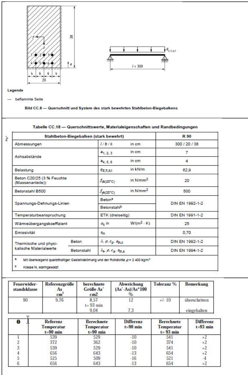
Da die errechneten Temperaturen deutlich geringer als die nach NA ausgewiesenen sind, ergibt sich für Beispiel CC4.9 auch eine gegenüber dem NA geringere Bewehrung, der Toleranzbereich wird leicht überschritten. Das deckt sich auch mit den Ergebnissen anderer Softwarehersteller, z.B. /65/.
