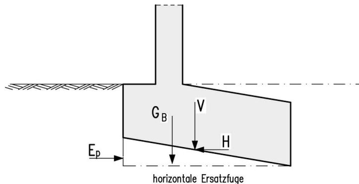
Ist die Sohlfläche der Winkelstützmauer geneigt, muss der Nachweis in der Sohle (mit gedrehten Lasten) als auch in einem horizontalen Schnitt unterhalb der Sohle, also durch das Erdreich, geführt werden. Die Lasten werden dabei immer automatisch vom Programm so gedreht dass diese normal (N) und parallel (T) zur Sohle wirken. Der ungünstigere Nachweis wird maßgebend. Die ÖNORM B4435-2 beschränkt den Sohlneigungswinkel auf  $\phi/3$ , der Grenzwert wird vom Programm überprüft.
