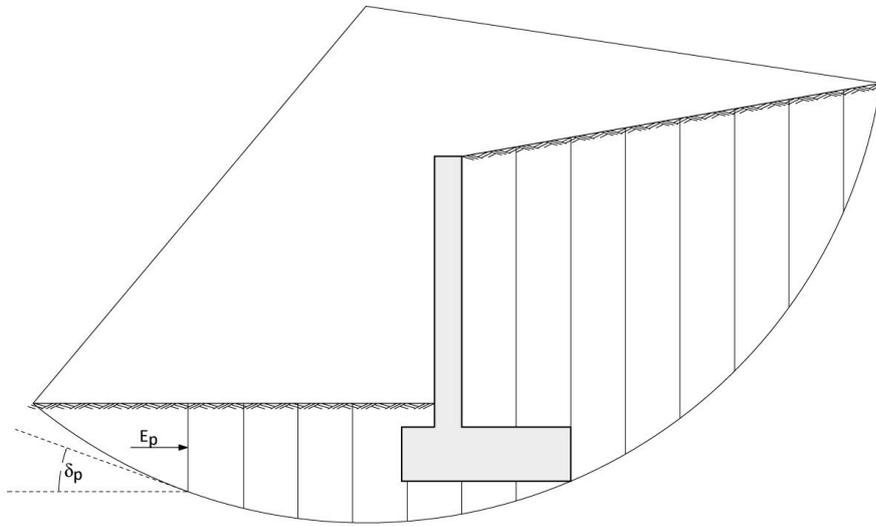
Die Böschung wird dabei auf der sicheren Seite liegend nicht berücksichtigt, wenn die letzte gültige Lamellengrenze in der Böschung liegt. Die Bodenschichtdicke, die für den Erdwiderstand angesetzt wird, ist immer die Differenz zwischen der Höhe der Austrittsstelle und der Tiefe der Gleitfuge an der letzten gültigen Lamellengrenze.
