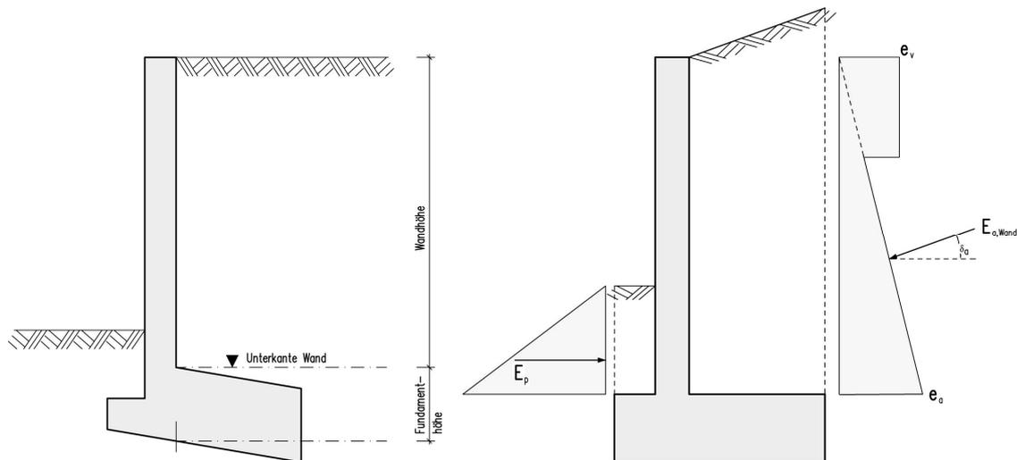
Der Verdichtungserddruck der für die Wand angesetzt werden kann ist unabhängig vom Verdichtungserddruck der in der Gleitfuge angesetzt wird, da an beiden Stellen verschiedene Erddruckansätze gewählt werden können.
