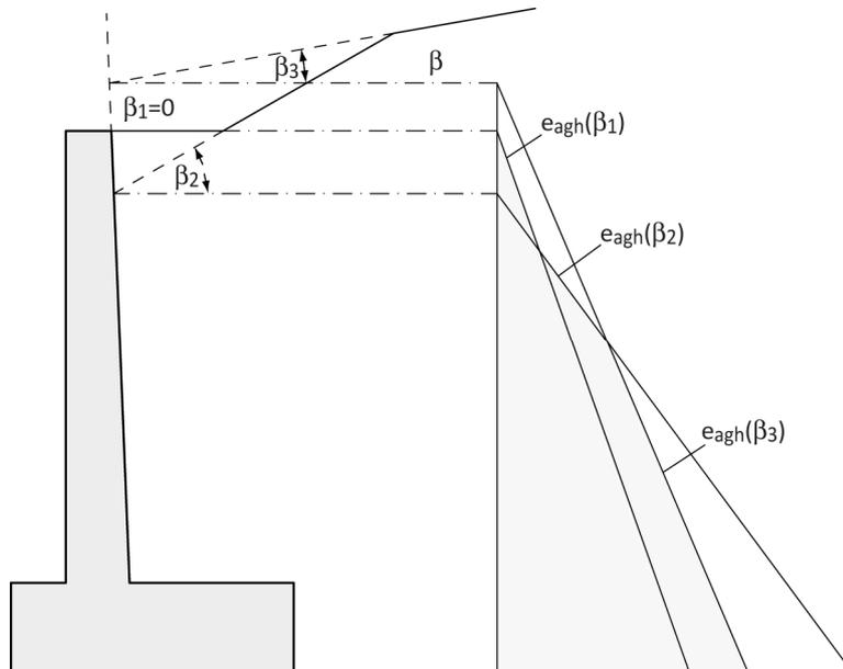
Der Erddruck wird immer als eine Einwirkung angesetzt, die entweder günstig oder ungünstig wirkt. Die Vertikalkomponente kann also nicht getrennt von der Horizontalkomponente betrachtet werden. Der Erddruck aus Eigengewicht wird allerdings getrennt vom Bodeneigengewicht betrachtet und dementsprechend kombiniert.
