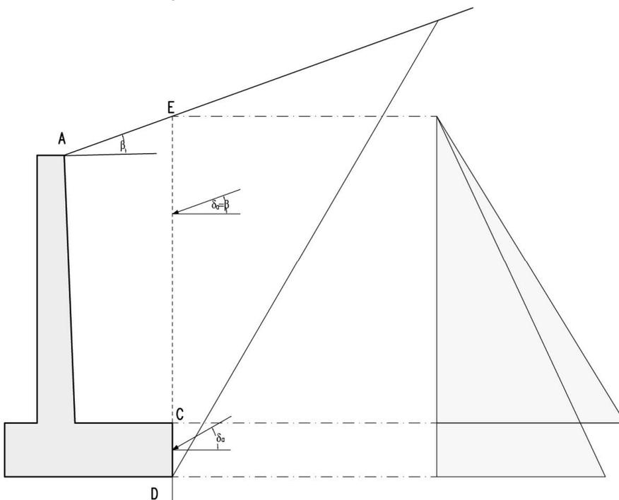
Der Erddruck unterhalb der Gleitfläche, der auf den bergseitigen Sporn wirkt, wird immer mit dem aktiven Erddruckneigungswinkel der Winkelstützmauer errechnet.
