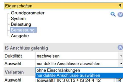
Im Knoten „Bemessung“ des Eingabebaums können verschiedene Optionen zum Verhalten bzgl. Nachweis erforderlicher Duktilität angepasst werden. Z.B. ob nicht ausreichend duktile Varianten in der Auswahltablelle angezeigt werden oder nicht.
