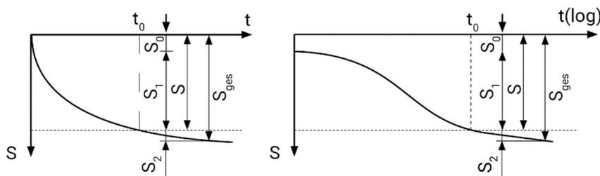
Abbildung 6: Zeitabhängige Setzungsanteile nach DIN 4019 Bild 4
