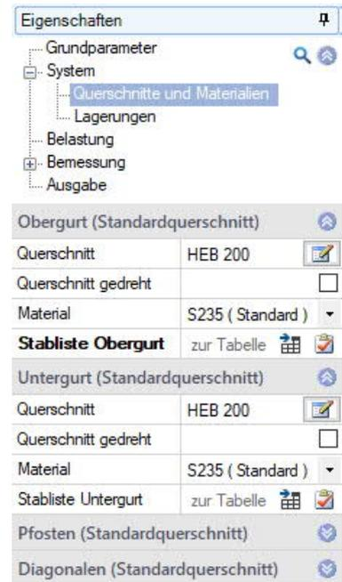
Sie können den Querschnitt aus der FRILO-Profildatei auswählen oder ihn über seine Abmessungen selbst eingeben (Benutzerdefiniert).
