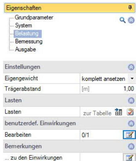
**Alternativ wirkend** Lasten einer Alternativgruppe werden immer einzeln angesetzt und nicht überlagert. Dabei ist zu beachten, dass bei der zusätzlichen Auswahl "Feldweise" jedes einzelne Feld mit dieser Last bereits alternativ betrachtet wird. Ist die Last als "nicht feldweise" definiert, wird die gesamte Last alternativ zu einer anderen Last der gleichen Alternativgruppe gesetzt.
